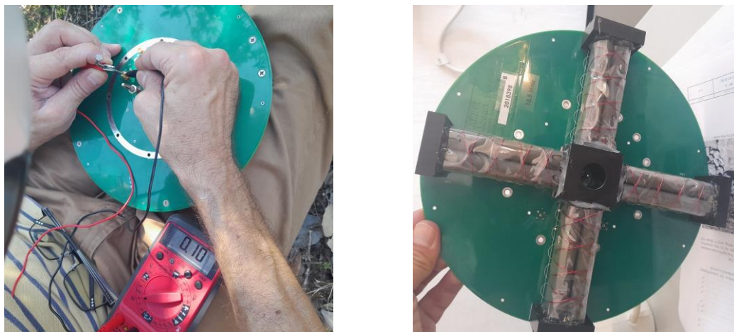
Fig.2. Misure effettuate dall'operatore sulla scheda elettronica (a sinistra). Dettaglio della scheda elettronica difettosa (a destra)
