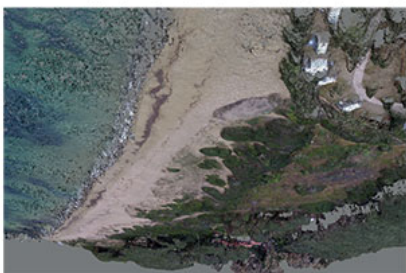
Ricostruzione tridimensionale della spiaggia di Lacona (Isola d'Elba) grazie alle immagini acquisite dal drone.
